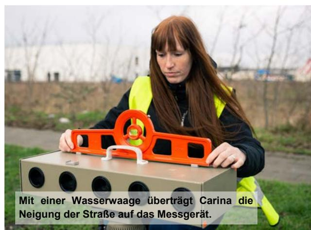
Mit einer Wasserwaage überträgt Carina die Neigung der Straße auf das Messgerät.
